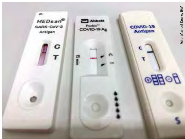
Die evaluierten SARS-CoV-2-Antigen-Schnelltests dreier Hersteller. Eine Bande bei C zeigt an, dass der Test technisch funktioniert hat. Eine Bande bei T zeigt ein positives Ergebnis, eine fehlende ein negatives.
