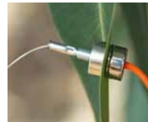
Sonda magnetyczna, którą mierzone jest zaopatrzenie w wodę: wynalazek Uniwersyteckiego Centrum Biologicznego
