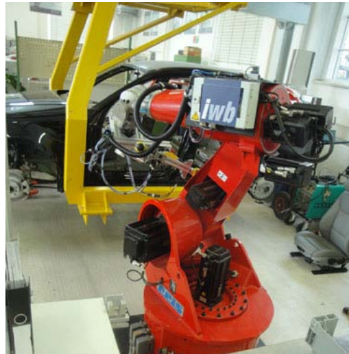
Roboterarm bei der Montage eines etwa 70 Kilogramm schweren Sitzes in ein Auto. Durch seine Hilfe werden die Arbeiter weder vom Gewicht des Sitzes noch von der komplizierten Einfädelprozedur belastet. Bild: Uni Würzburg/Informatik VII
