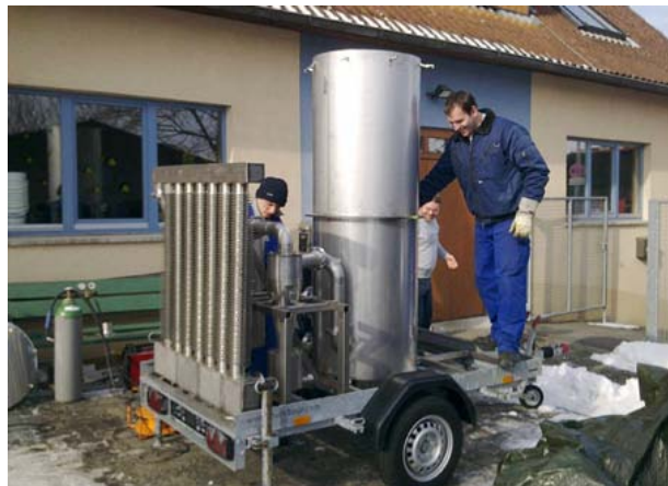
Arbeit am Holzvergaser im Hof der Bienenstation am Hubland. Foto: Beegroup Uni Würzburg
