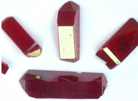
Einkristalle aus organischen Molekülen für den Einsatz als aktives Transportmaterial in thermoelektrischen Generatoren. (Foto Jens Pflaum)
