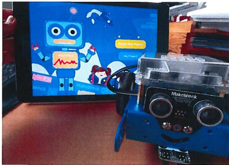
Der mbot ist ein kleiner Roboter den man über den PC steuern kann. Einmal gibt es die Möglichkeit, ihn mit dem Kabel direkt mit dem Computer zu verbinden oder eben kabellos. Dies funktioniert über den kleinen beigelegten Stick. Doch zuerst sollte man natürlich die benötigte Software runterladen. Dazu gibst du einfach mblock in die Suchleiste deines Computers ein und lädst die passende Software runter. (<http://www.mblock.cc/software/>). Kosten des Roboters ca.: 80€
