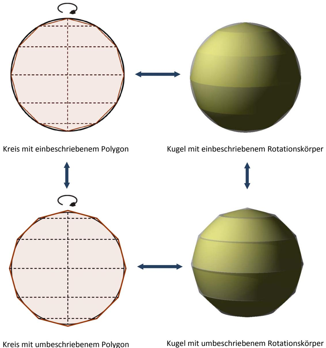
**Abb. 7: Analogie zwischen Polygon und Rotationskörper bei der Berechnung von Kugelvolumen und -oberfläche**
