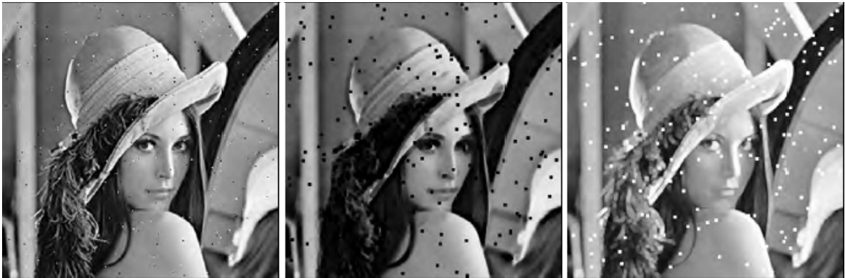
Abbildung 13: Wirkungsweise eines Minimum- und Maximum-Filters:
