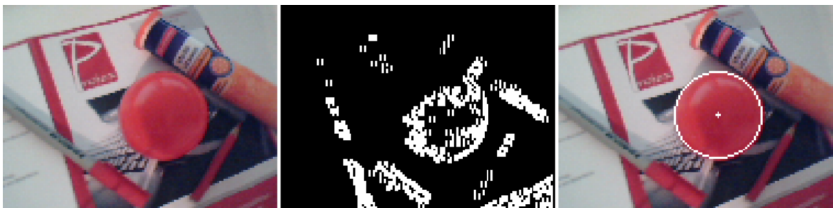
Abbildung 24: Kreisdetektion in einem Bild mit vielen Stör-Kanten:
