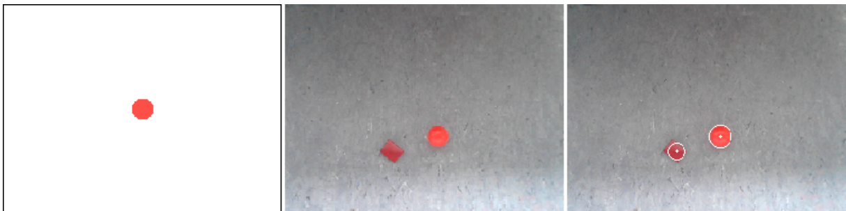
Abbildung 27: Unterschied zwischen positiven und negativen Fehler: links: zu suchendes Objekt (schematisch) Mitte: negativer Fehler rechts: positiver Fehler
