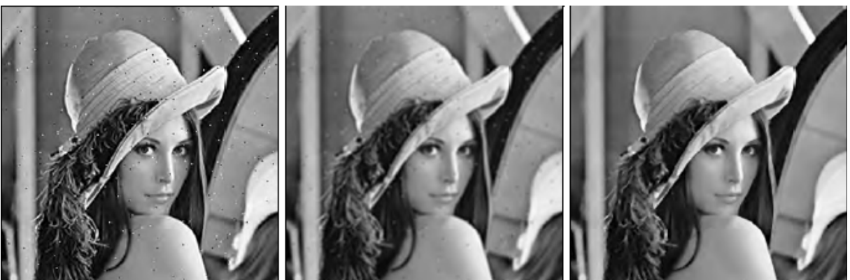
Abbildung 14: Wirkungsweise eines Median-Filters:
