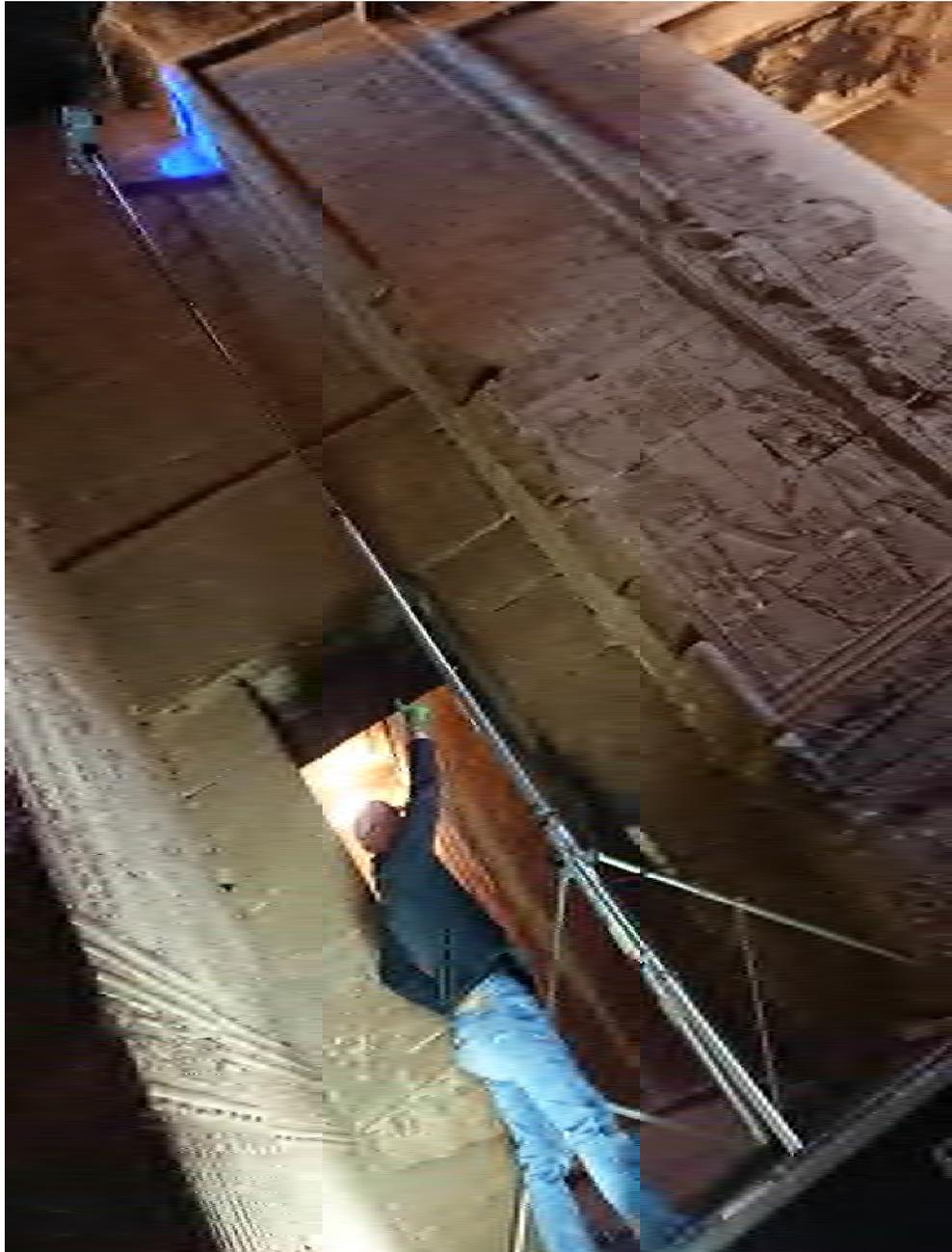
Abb. 5 Hochstativ hier mit dem 3D-Scanner aufgesetzt beim 3D-Scan (blaues Licht oben) an der Fassade des Sanktuars
