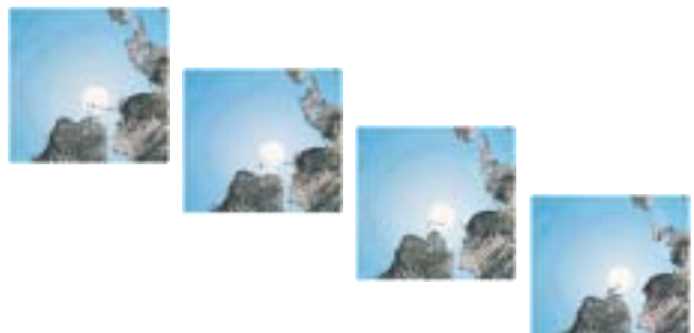
Oben: Auf der Basis eines digitalen Geländemodells und geeigneter Modellierungssoftware konnten Simulationen für Tsunami-Ereignisse erstellt und mit den Geländebefunden verglichen werden. Diese Simulationen helfen bei der Erfassung Tsunami gefährdeter Gebiete. Von links nach rechts sind Momentaufnahmen aus der Simulation 250, 450, 650 und 850 Sekunden nach der Entstehung der Welle zu sehen.
