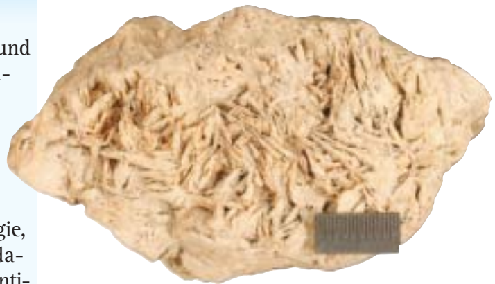
Oben: Lagerstättenerkundung ist ein Schwerpunkt geowissenschaftlichen Forschung. Am Beispiel Baryt zeigt sich die vielfältige Verwendung. So wird Baryt z.B. in Beton beigemischt, um in Krankenhäusern Röntgenstrahlen abzuschirmen. In der Automobilindustrie wird Baryt in Kunststoffe und Dämmmatten beigemischt, um die Schalldurchlässigkeit zu mindern.
