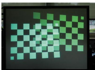
Abb. 5: Überlagerte Projektion, starke Projektorfehlstellung (rechts: Korrektur)
