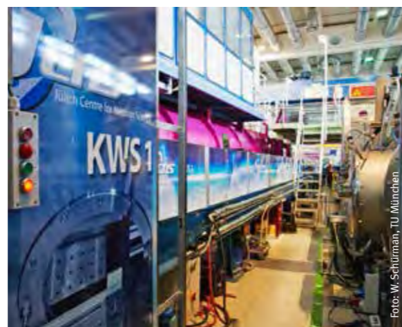
Die Neutronenkleinwinkelstreuapparatur eignet sich zur Untersuchung von Nanostrukturen.
