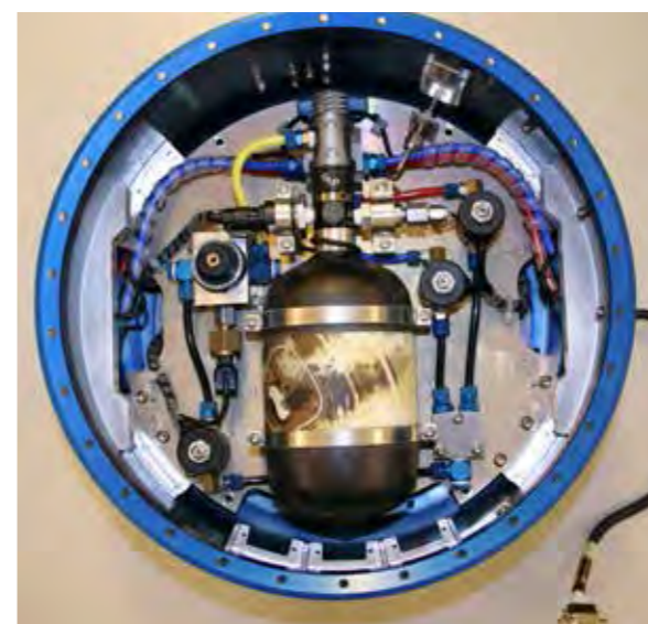
Das Drehraten-Kontrollsystem – in der Mitte ist der Tank eines Paintball-Gewehrs verbaut.
