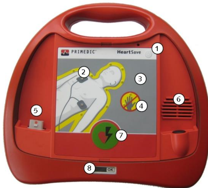
Abb. 4: HeartSave PAD Bedienelemente
